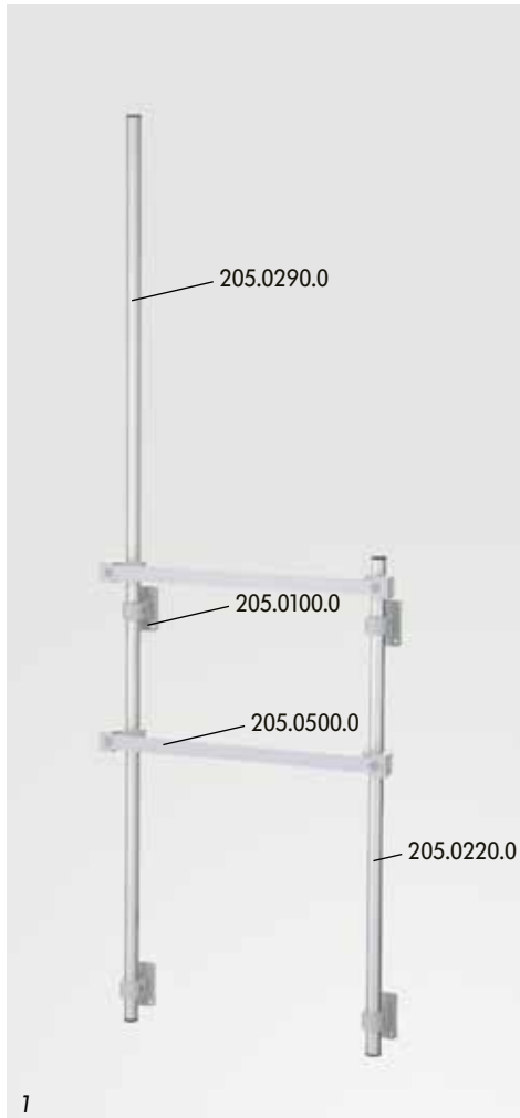
1 Gestell zur Aufnahme von Zubehör 205.4000.0 aus Aluminium/Kunststoff, seitlich am Funktionswagen montiert, bestehend aus: 4 St. Basisbefestigungselemente (205.0100.0) 1 St. Basisrohr 1500 mm (205.0290.0) 1 St. Basisrohr 800 mm (205.0220.0) 2 St. Geräteschiene 25 x 10 x 510 mm (205.0500.0)
