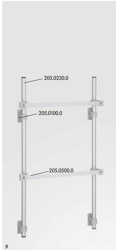
9 Gestell zur Aufnahme von Zubehör 205.4200.0 aus Aluminium/Kunststoff, seitlich am Funktionswagen montiert, bestehend aus: 4 St. Basisbefestigungselemente (205.0100.0) 2 St. Basisrohr 900 mm (205.0230.0) 2 St. Geräteschiene 25 x 10 x 510 mm (205.0500.0)
